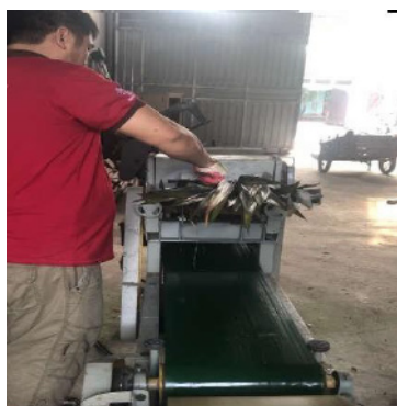
Hình 6. Tách sợi từ lá dừa trên thiết bị tự động
