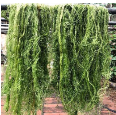
Hình 7. Sợi tự nhiên được tách từ lá dừa trên thiết bị tự động
