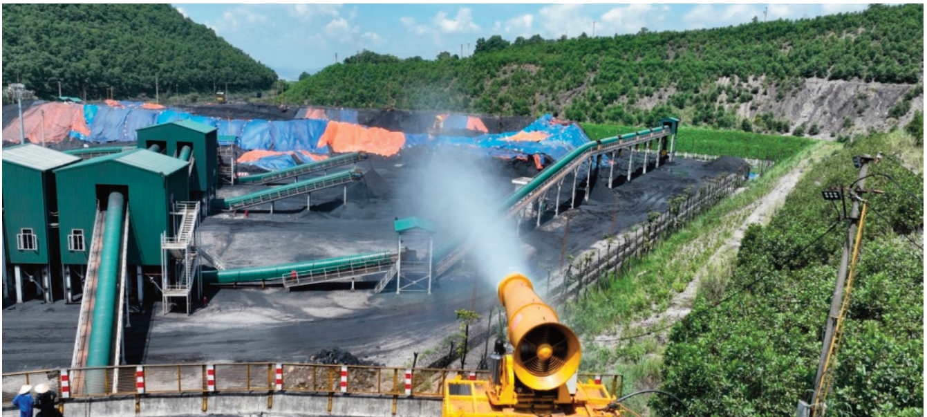
Hệ thống phun sương dập bụi và xe tưới nước chuyên dụng công suất lớn của công ty Hà Tu đã phát huy hiệu quả to lớn trong công tác bảo vệ môi trường tại khai trường sản xuất cũng như môi trường khu dân cư xung quanh.
